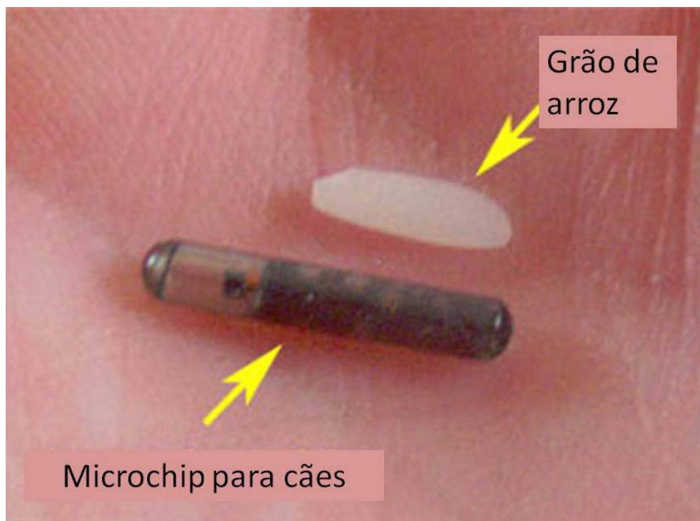
Figura 4. Microchip para cães em tamanho comparativo a um grão de arroz. http://www.appcessories.co.uk/gps-chip-for-dogs/
